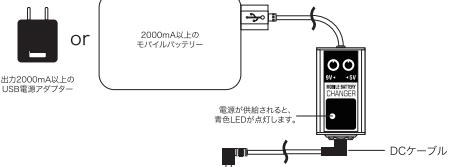
付属のDCケーブルを用いて、エフェクターに接続します。
